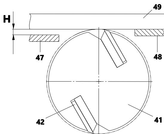
**Рисунок 4.** Схема проверки строгальных ножей
