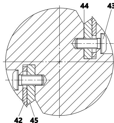
**Рисунок 2.** Схема крепления строгальных ножей
