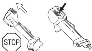
Запустите двигатель и проверьте, чтобы он остановился при переводе выключателя в положение стоп.
