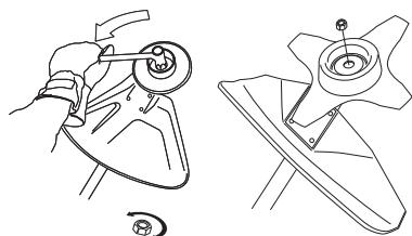
Нейлоновая прокладка контргайки не должна быть изношена настолько, чтобы ее можно было поворачивать вручную. Прокладка должна выдерживать усилие минимум 1,5 Нм. Гайку следует заменить после ее использования приблизительно 10 раз.
