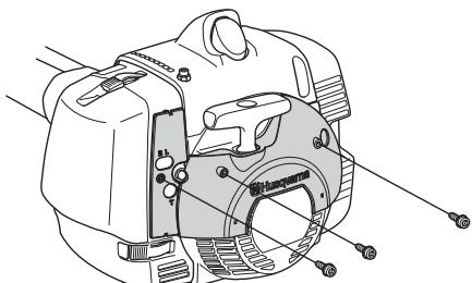
Демонтируйте воздушный фильтр машины и крышку воздушного фильтра. Смонтируйте
