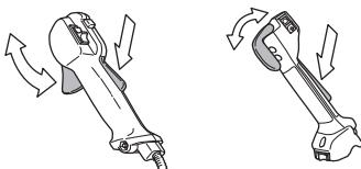
См. указания в разделе Запуск. Включите машину и полностью откройте дроссель. Отпустите рычаг дросселя и удостоверьтесь, что режущее оборудование останавливается и остается неподвижным. Если после постановки дросселя в положение холостого хода режущие оборудование продолжает вращаться, следует проверить регулировку холостого хода карбюратора. См. указания в разделе Техническое обслуживание.
