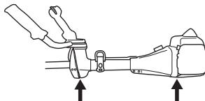
При работе с неправильно намотанной струной или неисправным режущим оборудованием уровень вибрации повышает. См. раздел Режущее оборудование.
