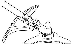
Проверьте, чтобы защита не была повреждена и чтобы на ней не было трещин. Замените защиту, если она была подвергнута удару или если на ней есть трещины.
