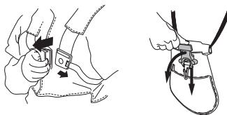
Убедитесь, что привязные ремни оснастки были правильно расположены. Когда машина будет отрегулирована, проверьте работу системы быстрого отстегивания оснастки.
