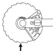
При ослаблении и затягивании гайки лезвия для пиления, рука может быть травмирована зубьями лезвия. Страйтесь, чтобы при этой работе ваша рука всегда была защищена щитком лезвия. Эта задача облегчается за счет использования длинного торцового ключа. На иллюстрации стрелкой показан участок, в котором следует располагать торцовый ключ при ослаблении и затягивании гайки.
