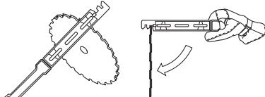
Проверьте режущее оборудование на наличие повреждений или трещин. Поврежденное режущее оборудование следует обязательно заменить.
