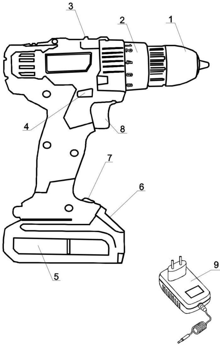
1 - патрон; 2 - переключатель предельных моментов; 3 - переключатель диапазонов; 4 - переключатель реверса; 5 - аккумуляторный блок; 6 - фиксатор; 7 - диод светоизлучающий; 8 - выключатель; 9 - зарядное устройство.
